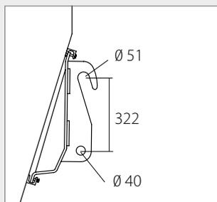
3. Weidemann hydraulische Verriegelung Obere Einhängehöhe: 915 mm
