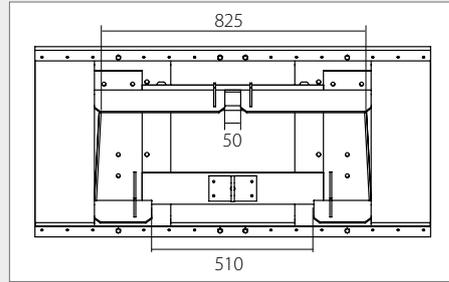
5. Schäffer-Hoflader mechanische Verriegelung Obere Einhängehöhe: 966 mm
